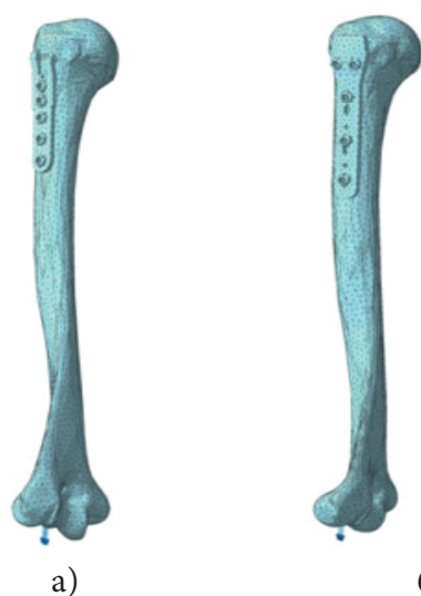
Рисунок 5 - Конечно-элементная сетка системы «кость-фиксатор» а - с устройством для накостного остеосинтеза ППОПК; б - с устройством с угловой стабильностью винтов для накостного остеосинтеза ППОПК
